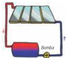
Aquecedor Solar com Bomba Hidráulica
