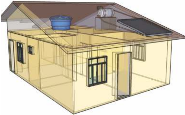
Esquema de aquecedor solar instalado pelo sistema convencional - RT Interno e Coletor Externo ao telhado
