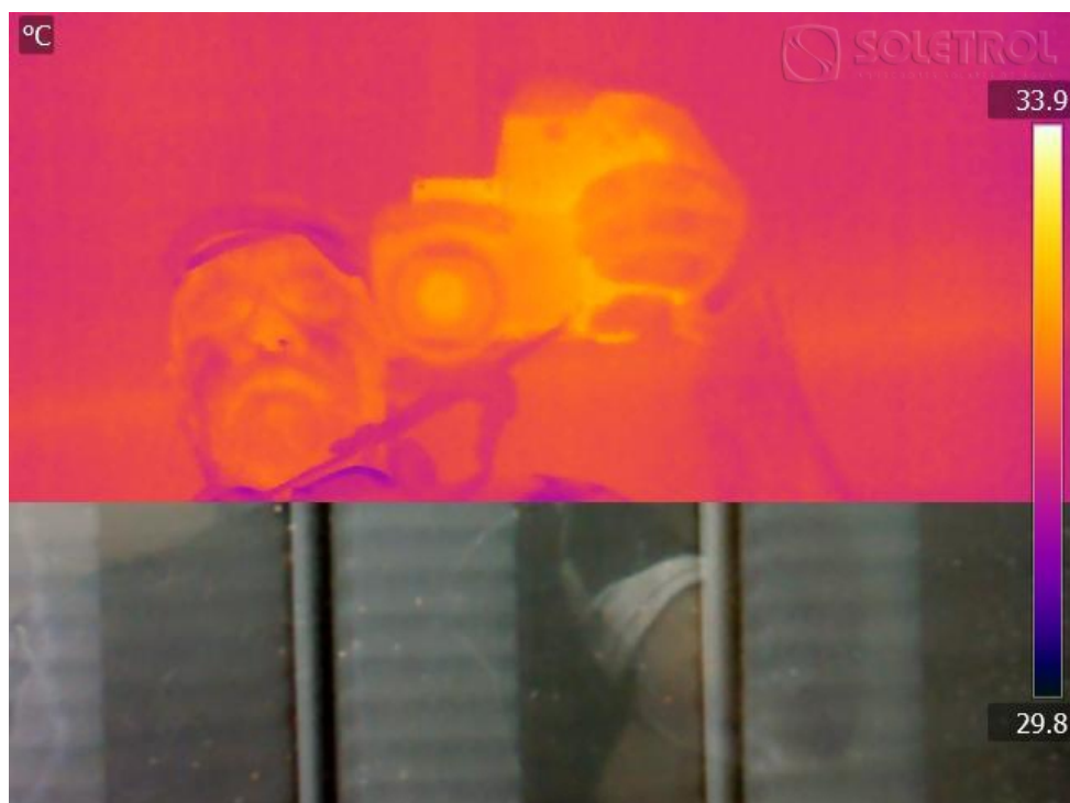
Foto 13 - Vidro do coletor solar refletindo a radiação infravermelha
