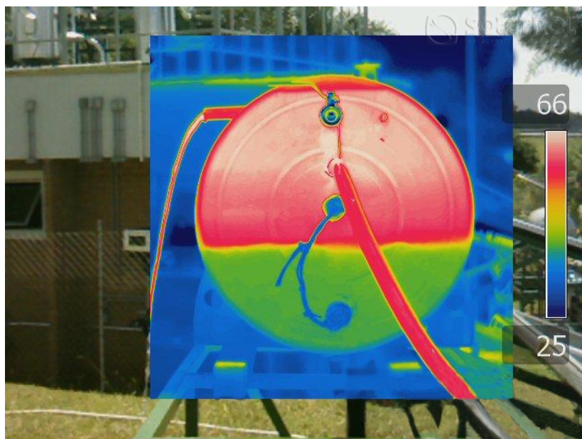
Foto 34 - Imagem infravermelha do reservatório sendo esvaziado a 6 min
