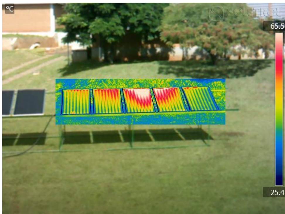
Foto 59 - Imagem infravermelha de 5 coletores ligados em Z com fluxo de aproximadamente 54 l/h.m 2
