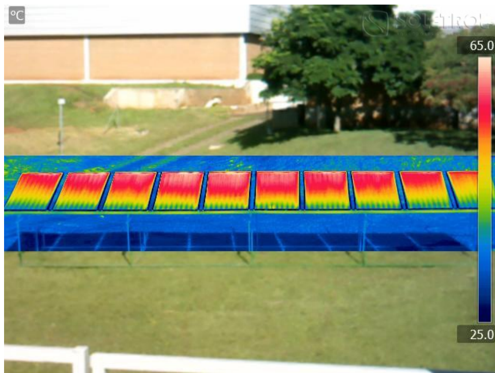
Foto 64 - Imagem infravermelha de 10 coletores ligados em “Z” com fluxo de aproximadamente 4,5 l/h.m 2
