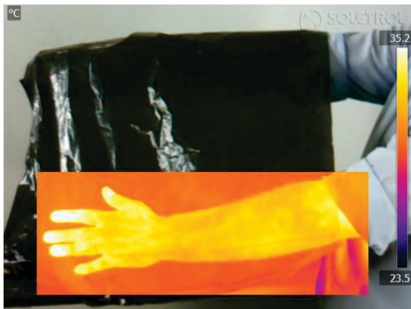
Foto 10 - Exemplo de placa de polietileno sendo atravessada pela radiação infravermelha
