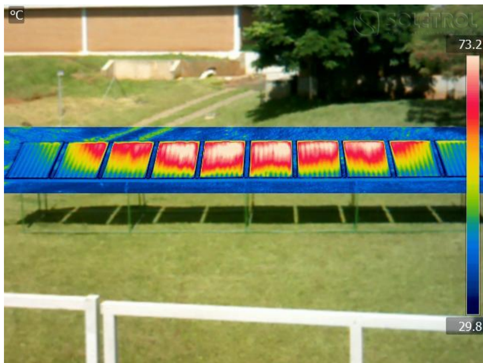
Foto 63 - Imagem infravermelha de 10 coletores ligados em “Z” com fluxo de aproximadamente 18 l/h.m 2
