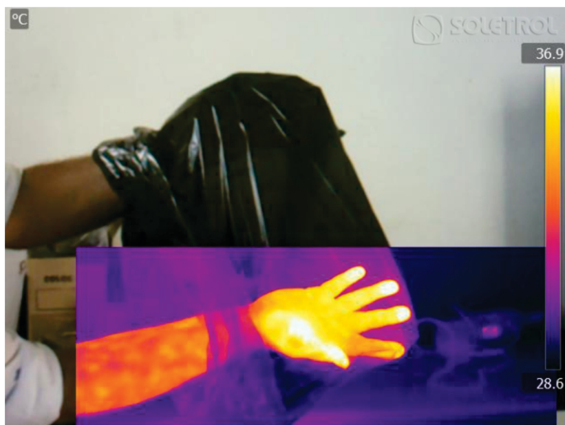
Foto 11 - Exemplo de placa de polietileno sendo atravessada pela radiação infravermelha
