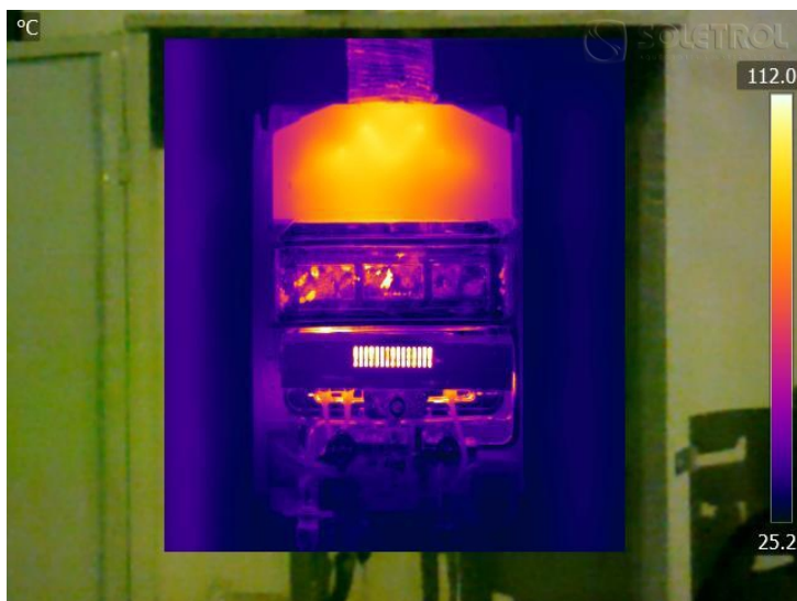
Foto 113 - Imagem infravermelha de aquecedor a gás em funcionamento
