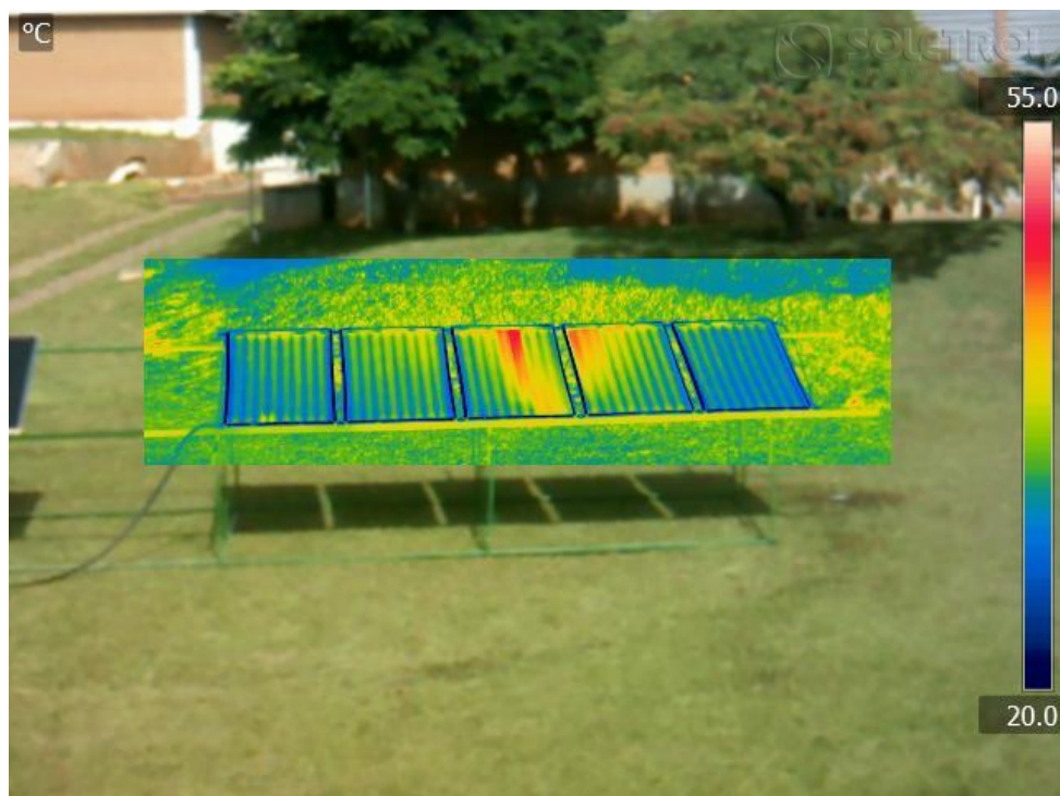
Foto 61 - Imagem infravermelha de 5 coletores ligados em “Z” com fluxo de aproximadamente 106 \text{ l/h.m}^2
