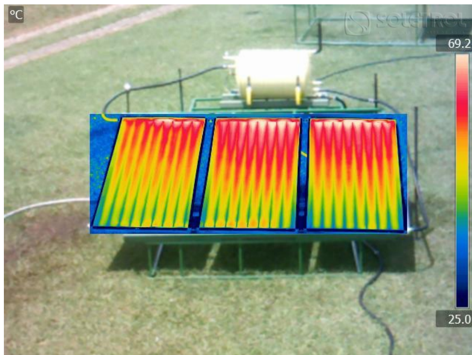
Foto 54 - Imagem infravermelha de coletores solares conectados em paralelo com ligação em Z
