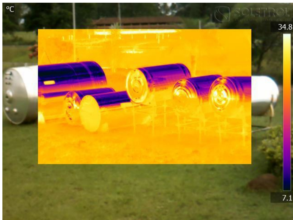
Foto 15 - Capas metálicas que refletem a luz visível refletindo a radiação infravermelha
