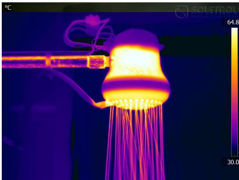
Foto 110 - Imagem infravermelha de chuveiro desligado usando água do aquecedor solar
