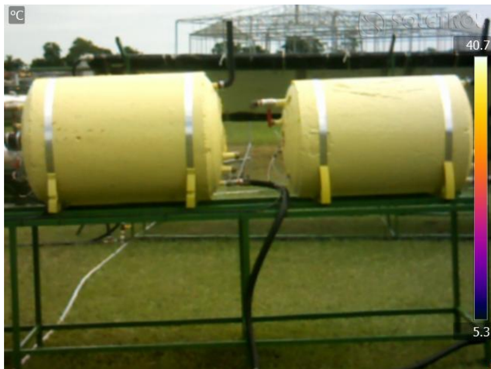
Foto 88 - Imagem comparativa de reservatórios térmicos com espessuras diferentes de isolamento
