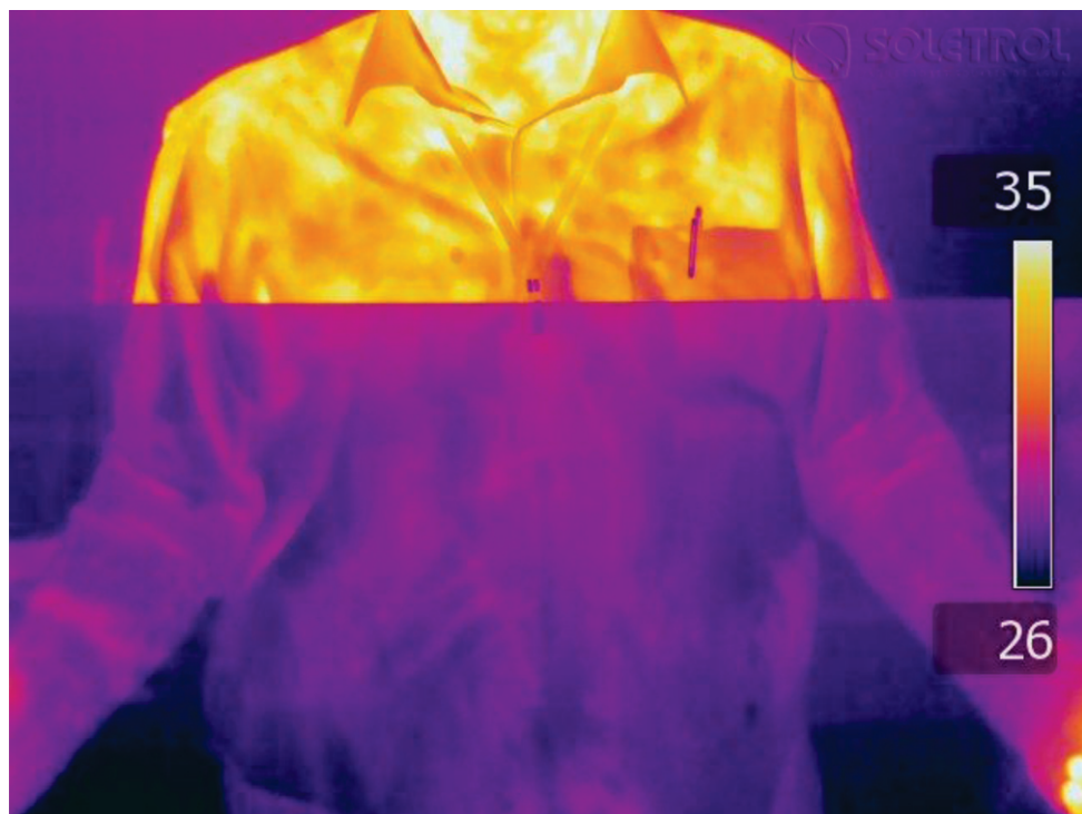
Foto 09 - Exemplo de placa de polietileno sendo atravessada pela radiação infravermelha
