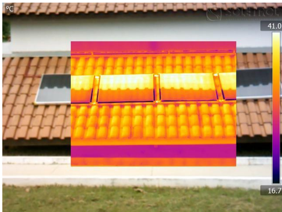
Foto 14 - Vidro do coletor refletindo a radiação infravermelha
