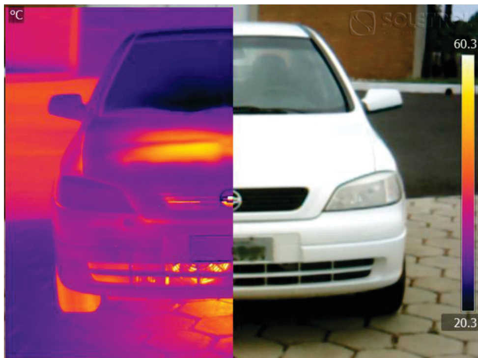
Foto 05 - Imagem infravermelha fundida com a imagem digital na faixa do visível
