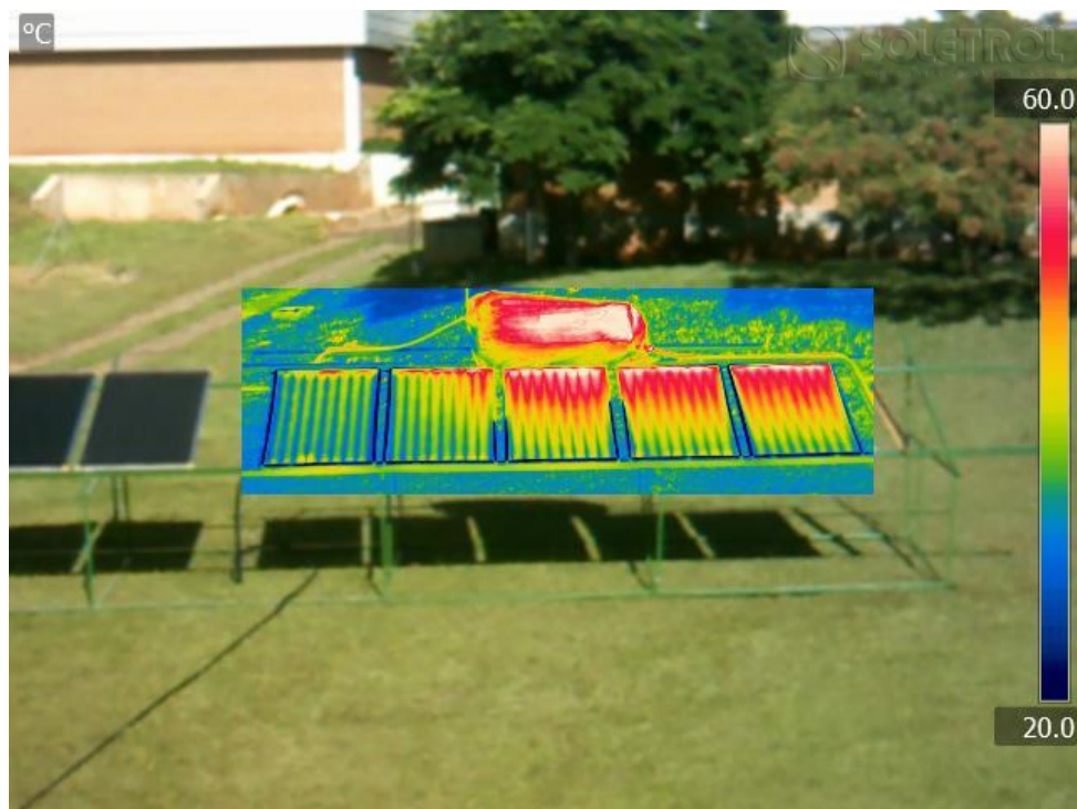
Foto 62 - Imagem infravermelha de 5 coletores ligados em “U” com fluxo de aproximadamente 42 l/h.m 2
